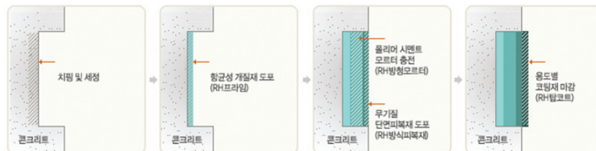
[ 단면복구공법 시공 공정 사례 (건설신기술 330호) ]
