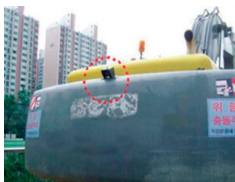
<후방 감시카메라 설치>
