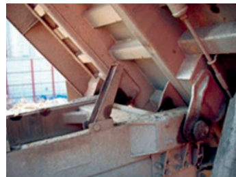
<정비 시 안전블럭 설치>
